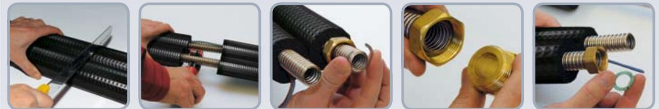
Découper les tubes à angle droit dans un creux d'ondulation et veiller à obtenir un bord de coupe net. Enfiler l'écrou de raccordement dans le tube flexible. Monter ensuite la bague de serrage dans le premier creux d'ondulation, de manière à pouvoir fermer la bague. Utiliser le mamelon fileté fourni pour réaliser la surface d'étanchéité par serrage.
