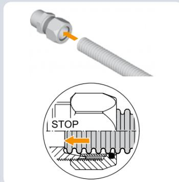
Coupez les tubes à angle droit dans le creux de l'ondulation à l'aide d'un coupe tube pour tubes annelés en acier inoxydable. Veillez à obtenir un bord de coupe net. Insérez le tube annelé dans le raccord jusqu'au fond.
